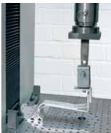
Dachanker Pfanne 3 Al, Drucklastprüfung
