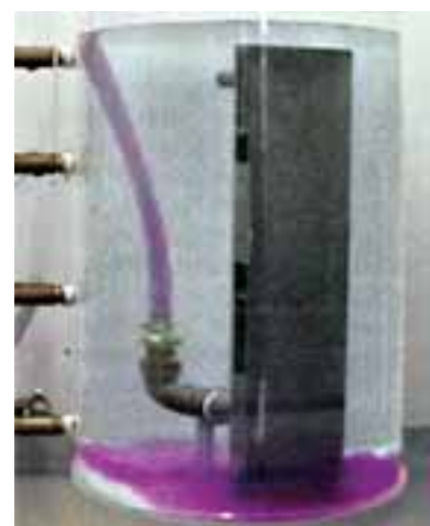
Kalter Heizungsrücklauf strömt in heißen Speicher
