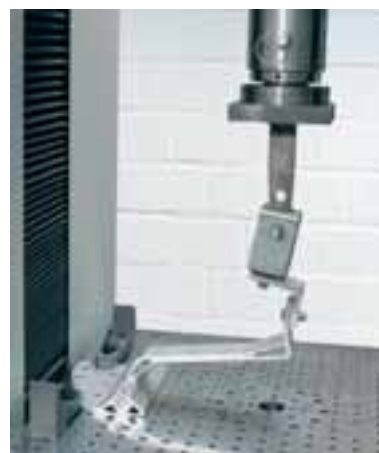
Dachanker Pfanne 3 Al, Zuglastprüfung
